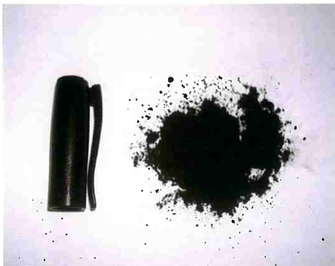
Figura 18. Carvão vegetal após moagem em moinho de bolas, com granulometria abaixo de 100 mesh, para utilização na fabricação de pelotas.
