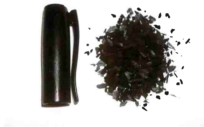
Figura 17. Carvão vegetal após moagem em moinho de facas e peneirado, com granulometria entre 9 e 100 mesh.
