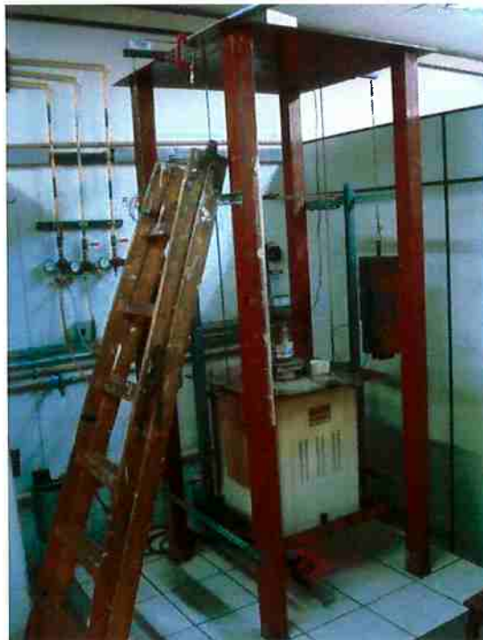
Figura 27. Forno elétrico de resistências utilizado nos ensaios de termogravimetria.
