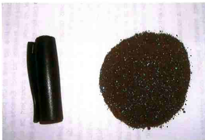
Figura 19. Pellet feed da Vale, utilizada na fabricação das pelotas.
