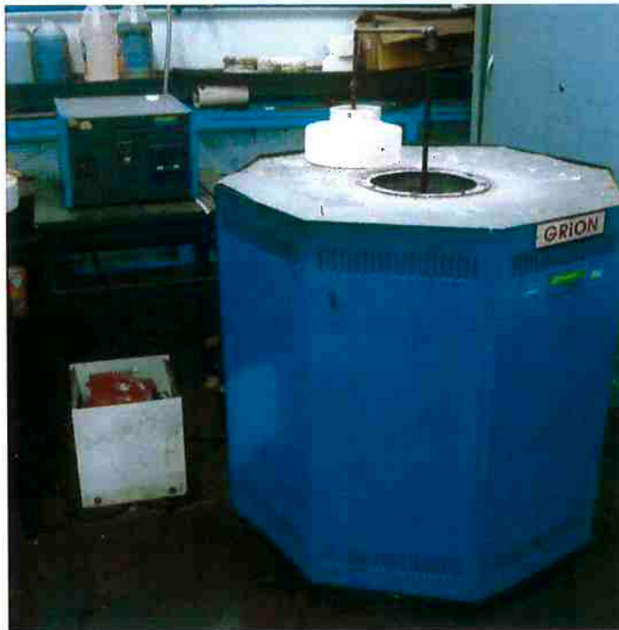
Figura 22. Forno elétrico de resistências tipo poço utilizado na carbonização da madeira.
