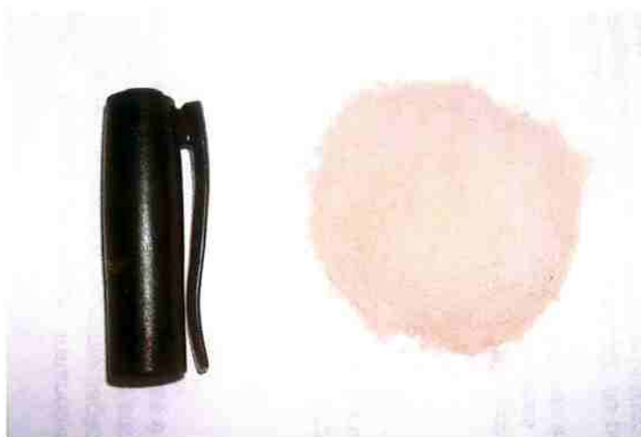
Figura 20. CMC utilizado na fabricação das pelotas.
