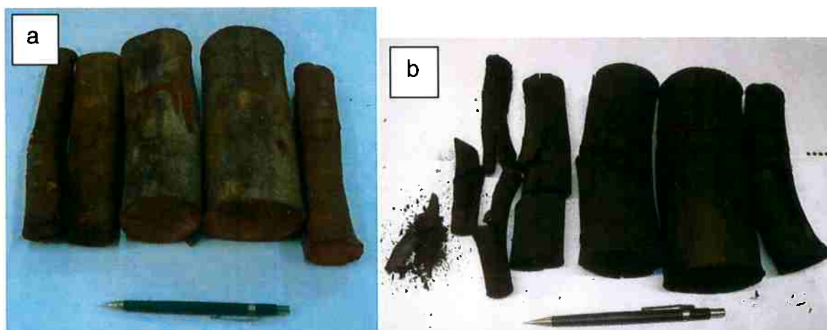
Figura 25. Aparência das amostras de madeira (a) antes, (b) depois da carbonização. Carbonização feita a 500°C e 1 hora depois do pico de temperatura.
